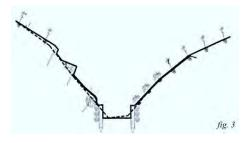
Molto spesso nel fossi di versante si verificano frane di sponda e tracimazioni delle acque invadono ed erodono campi, per mitigare, per risolvere tale problema serve diminuire la pendenza delle sponde e sistemarle con opere Ingegneria Naturalistica, riprofilatura inoltre, aumenterà la sezione dell'alveo con maggiore capacità di veicolare portate maggiori con velocità di scorrimento minori.
