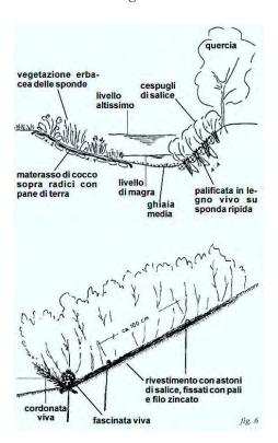
Le difese spondali risultano necessarie in presenza di una dinamica geomorfologica di erosione verticale, come nei casi a valle delle briglie.
