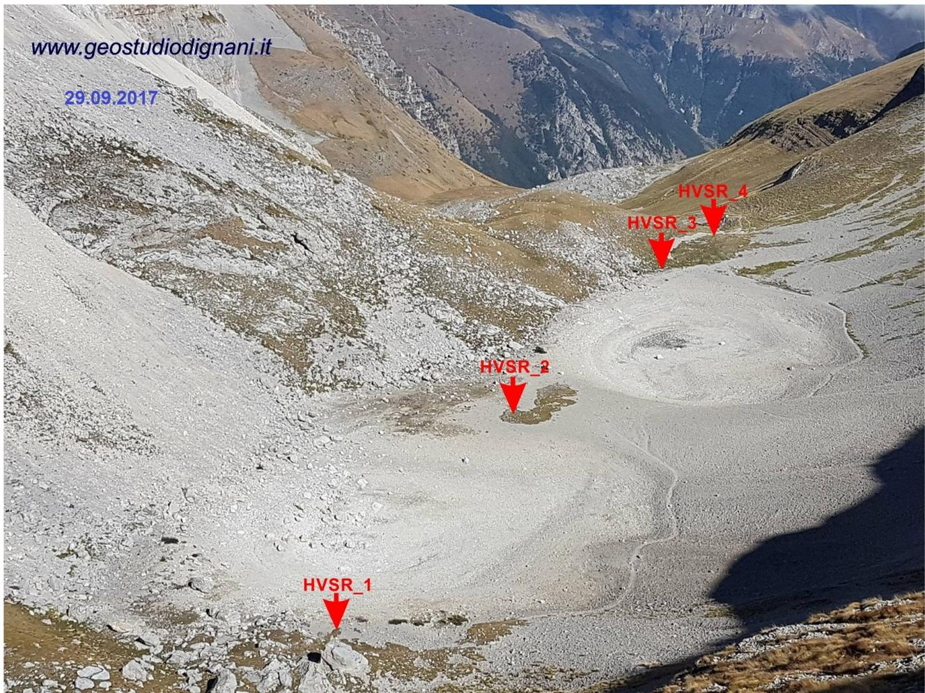
Un suolo, infatti, vibra non solo quando è eccitato da un terremoto ma anche quando è eccitato da un tremore di qualsiasi origine, anche di minima entità. Ciò fa sì che la misura delle frequenze di risonanza dei terreni sia possibile ovunque anche in assenza di terremoti, semplicemente sfruttando il rumore sismico che è presente in un dato contesto ambientale e
