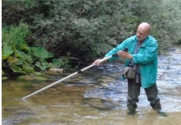
Fig.5.15 – Analisi velocità idrica in un torrente con Correntometro (da [www.geostudiodignani.it](http://www.geostudiodignani.it))
