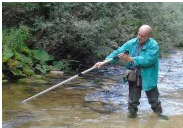
Fig.5.15 – Analisi velocità idrica in un torrente con Correntometro (da www.geostudiodignani.it )
